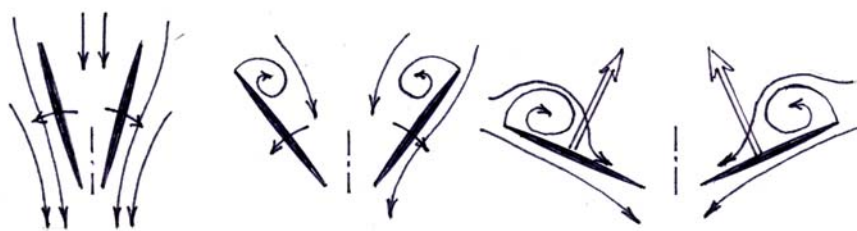
Obr. 5. Vznik náběžného víru při prudkém rozevření křídel.
